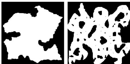
Figuur 8 Twee testbeelden die perfect kunnen worden gereconstrueerd door in een iteratief proces telkens deelproblemen voor twee projectierichtingen op te lossen. Voor het eerste beeld zijn vier projectierichtingen nodig, voor het tweede beeld acht.
