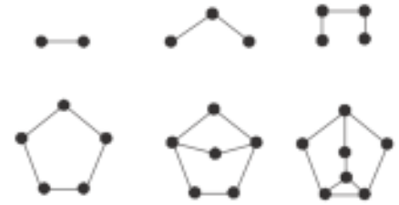
Figuur 2 Optimale netwerken tot en met n = 7 .
