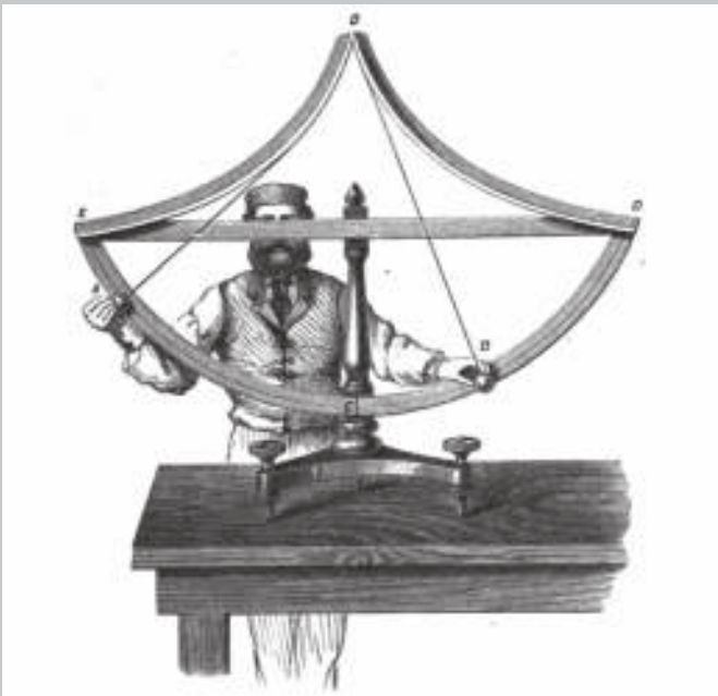
Bij een cycloïdale baan is de slinger synchroon. Uit: Robert Stawell Ball, Experimental Mechanics: A Course of Lectures Delivered at the Royal College of Science for Ireland , MacMillan and Co., New York, 1871.
