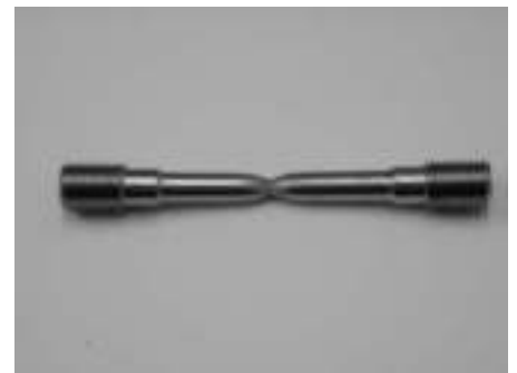
Figuur 2 Een metalen buis met een nek die ontstaan is doordat er teveel kracht op de buis stond.
