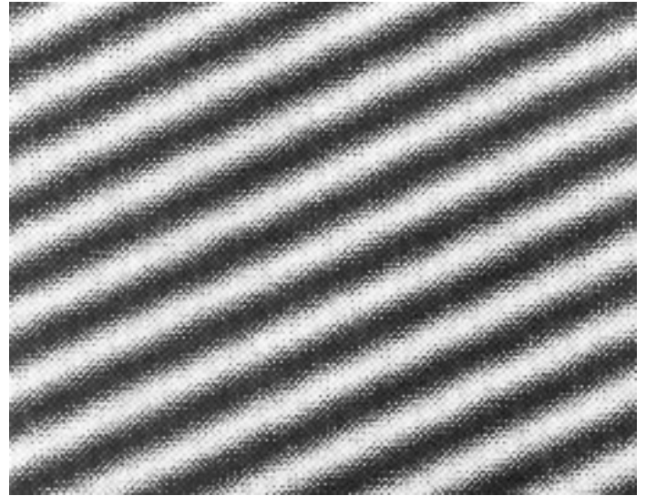
Figuur 5 Een 'bijna perfect' periodiek streep patroon in een chemische reactie. De concentratie van een van de reagerende stoffen is hoog in de lichte gebieden en laag in de donkere.
