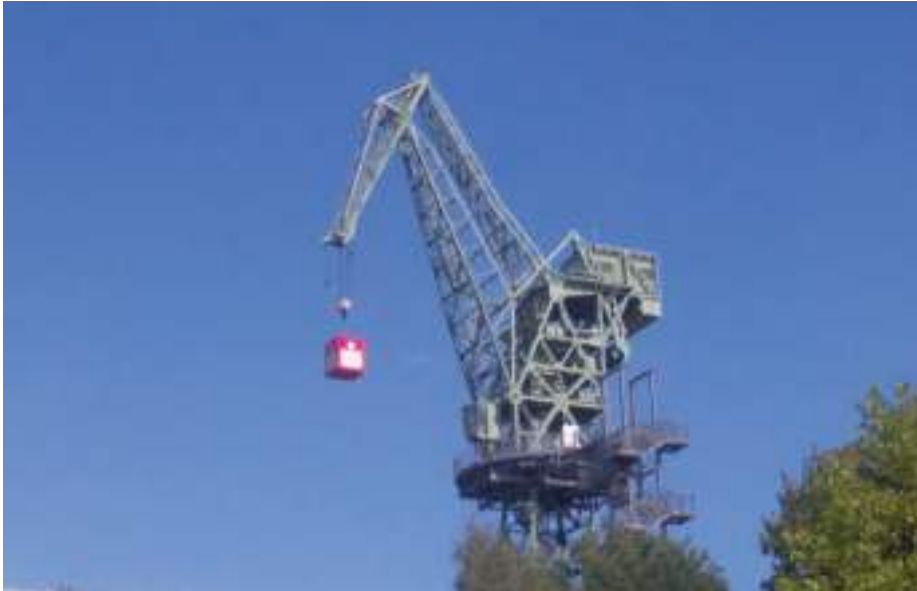
Figuur 5 'Der Eber' in Eberswalde: Dit Doppellenkersystem für Drehkrane werd 1932 aldaar door de Ardel-Werke uitgevonden.
