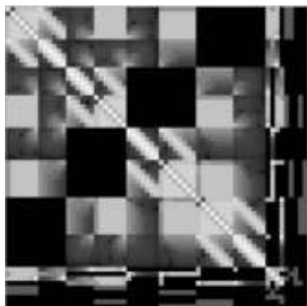
Figuur 9 Fill-in patronen van een Schur-complement voor gepreconditioneerde (ijle en volle) matrices.
