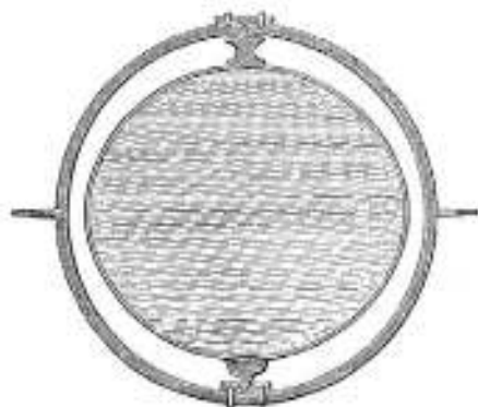
Figuur 3 Kelvin's draaiende, met water gevulde koperen 'rugbybal' met handvatten [5].
