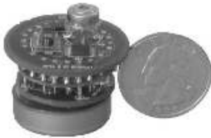
Figuur 1 Een sensor die in een draadloos sensornetwerk gebruikt kan worden.
