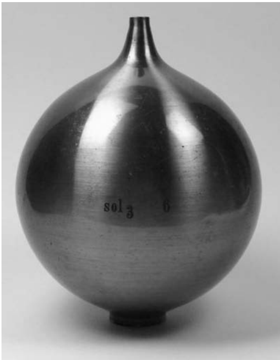
Figuur 11 Helmholtz was vindingrijk in het ontwikkelen van instrumenten waarmee hij geluid kon bestuderen. Het hier afgebeelde object is bedoeld om lage tonen te kunnen onderscheiden. Op pagina 43 van [4] beschrijft hij deze resonator, die met de tuitvormige bovenkant in het oor dient te worden gezet. Het geluid komt door de cirkelvormige, open onderkant naar binnen. De tuitvormige bovenkant wordt ingesmeerd met hete was die men laat afkoelen totdat aanraking met het oor te verdragen is. Op deze manier ontstaat er een luchtdichte verbinding met het instrument. Op deze manier bestudeerde Helmholtz de laagste tonen, bijvoorbeeld in het geratel van koetswielen en in opspattend water.
