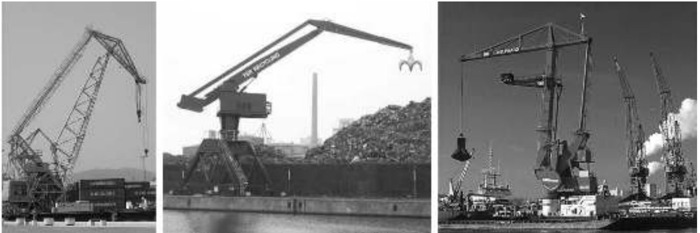
Figuur 1 Een lemniscaat-, een balans- en een 'floating level-luffing' kraan
