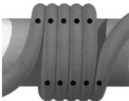
Figuur 8 Strengen oefenen alleen kracht op elkaar uit bij de aangegeven punten.
