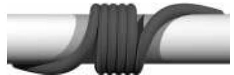
Figuur 7 Een globale minimizer van het contactprobleem
