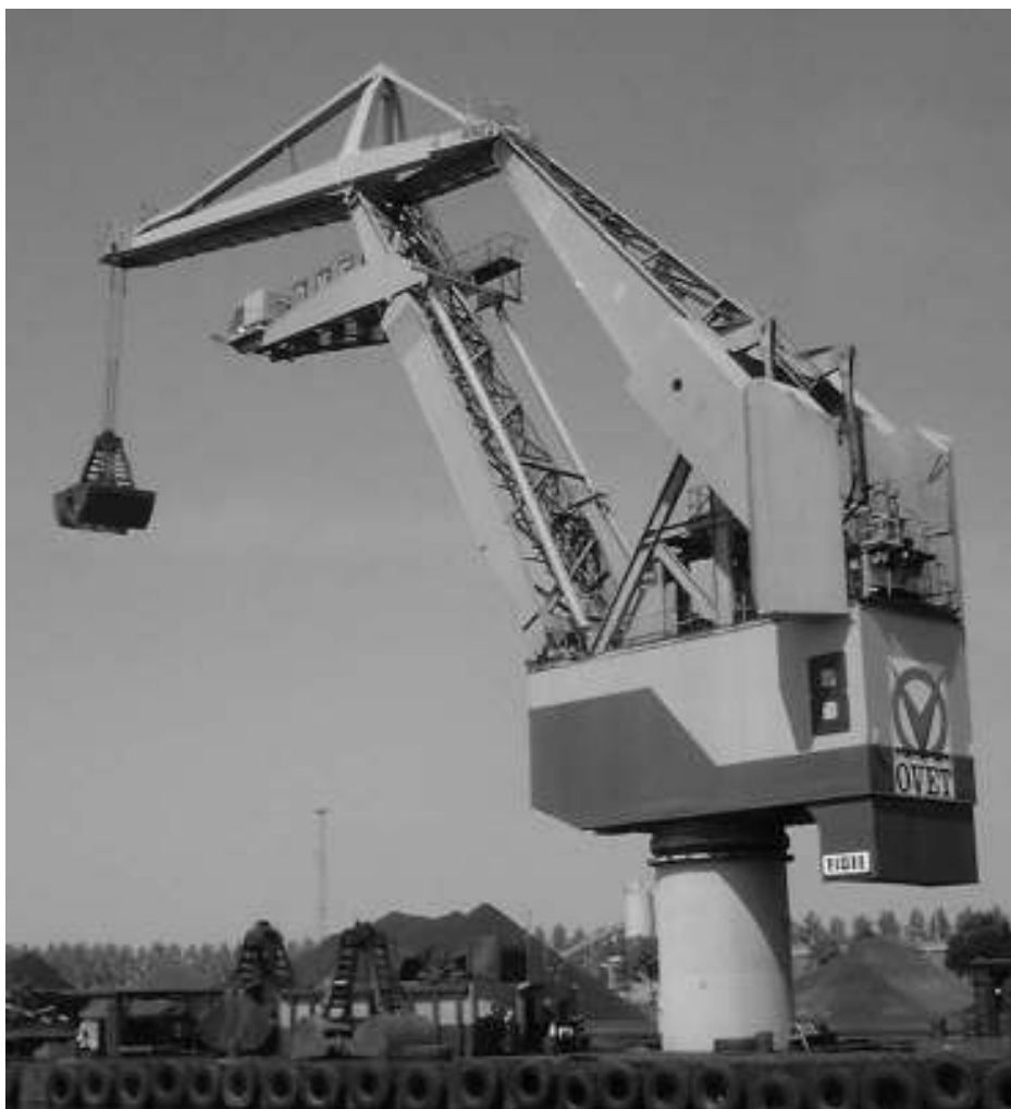
Figuur 3 De balancerende van de lemniscaatkraan is in veel gevallen gezocht in de achterarm. Hier vormt de ballastbak een geheel met de achterarm.
