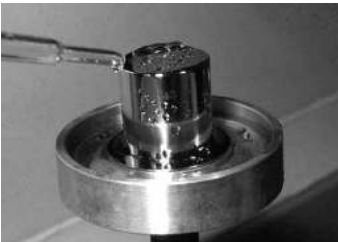
Figuur 2 Het wassen van de platinum-iridium cilinder (uit: Davis R.S., Possible new definitions of the kilogram, Phil. Trans. Royal Soc. A, 2005, 363, 2249-2264)
