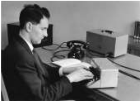
De brailletelefoon: de zes punten van het brailleschrift worden vertaald in zes verschillende frequenties, die vervolgens via een gewone telefoonlijn worden verzonden.
