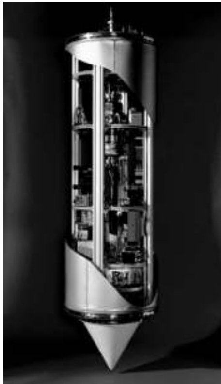
Figuur 8 Schets van de valtoeren in Bremen en een capsule met de registratieapparatuur. De val duurt 4,7 seconden.
