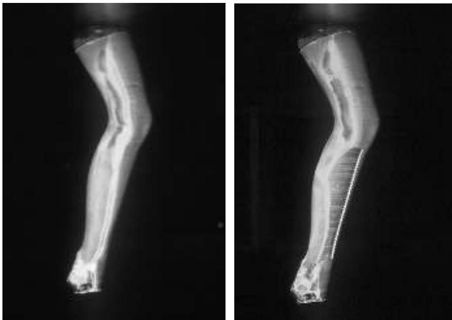
Figuur 6 Het effect van zigzagtape op de loslaatlijn. Het been links vertoont vroege laminaire loslating (de dikke lijn door het midden van het been). Het been rechts heeft turbulente loslating ten gevolge van de zigzagstrip.
