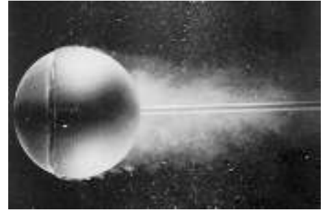
Figuur 2 Visualisatie van de stroming om een bol met behulp van rook. Links laat de laminaire grenslaag los. Rechts wordt via een groef langs kunstmatige weg de stroming turbulent gemaakt, zodat het zog kleiner wordt. 2
