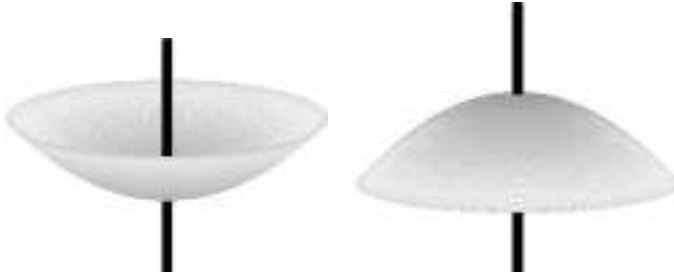
Figuur 6 Potentiële isofootvlakken door een Morse extremum. Dit laatste genereert volgens de impliciete functiestelling een niet-horizontale curve in de (x, t) -ruimte ( t neemt toe naar boven). Links. Toelaatbaar. Rechts. Ontoelaatbaar.
